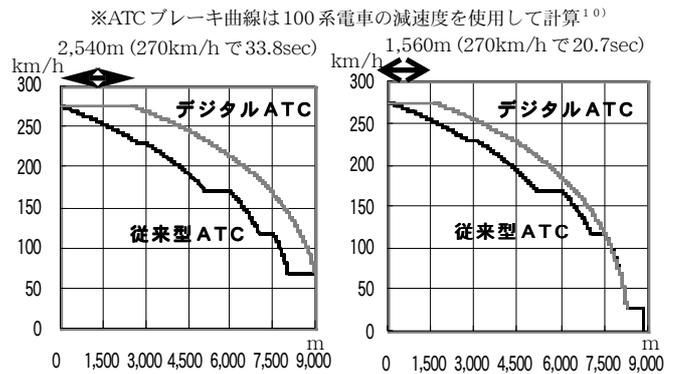
※ATCブレーキ曲線は100系電車の減速度を使用して計算<sup>10)</sup>
