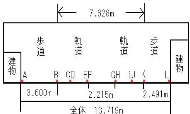
図-10 ヴィタル・カルル通り(ボルドー, 仏)の断面図
